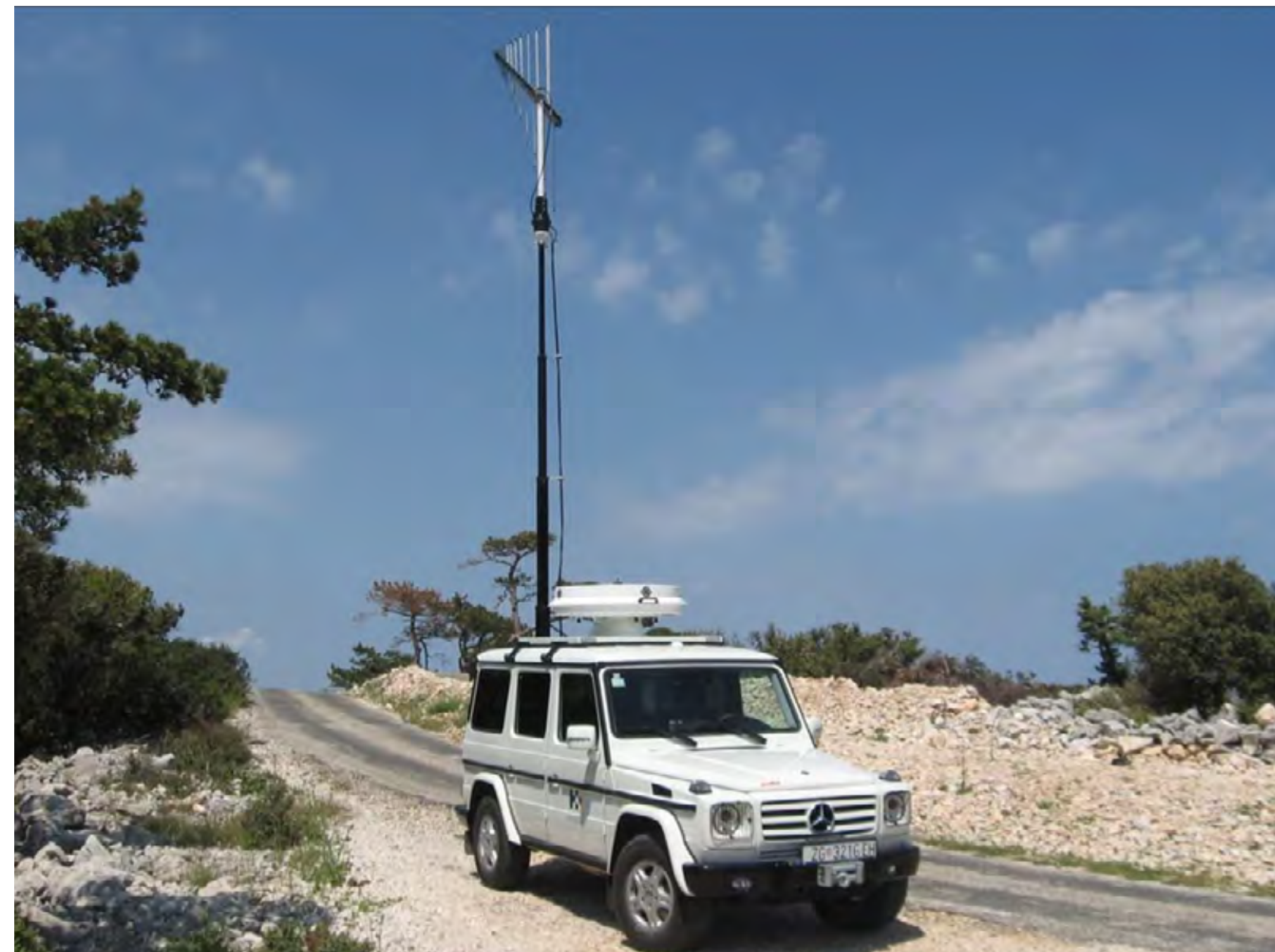
Slika 5.4. Mjerno vozilo tijekom mjerenja talijanskih smetnja
