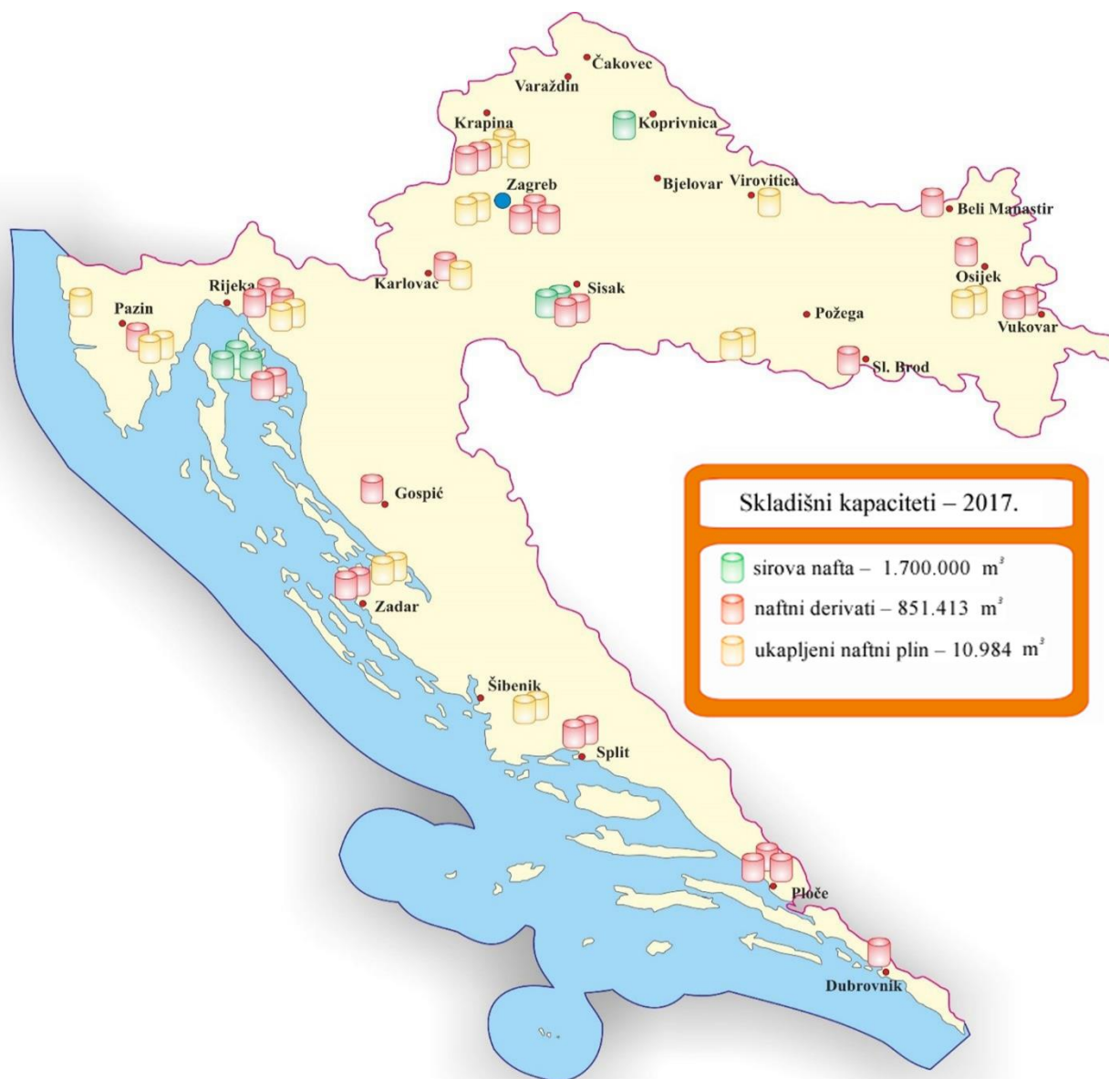
Slika 6.3.1. Zemljopisni položaj skladišta za naftu i naftne derivate s obzirom na tip robe koja se skladišti te ukupni skladišni kapaciteti u 2017. godini
