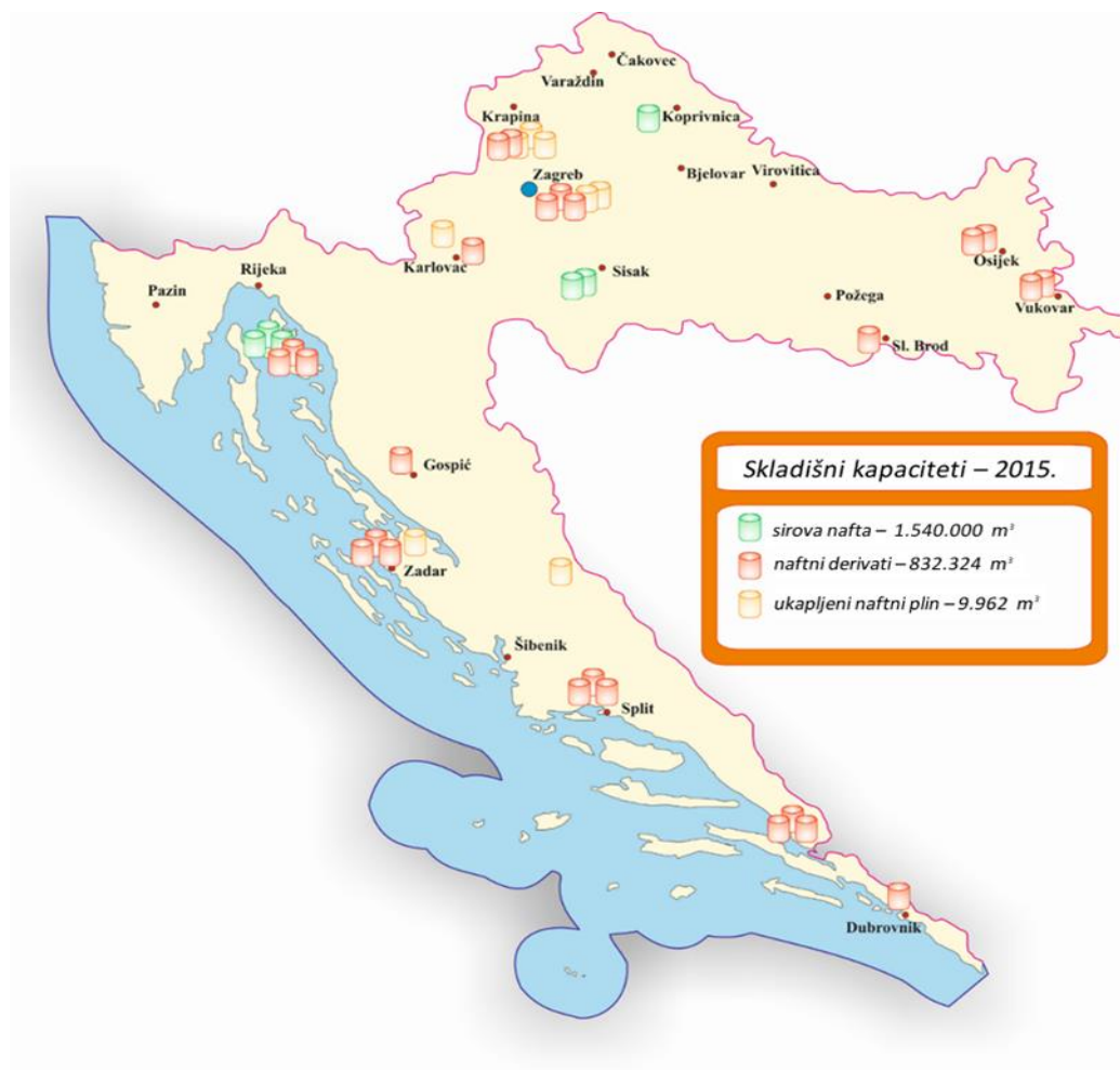
Slika 6.3.1. Zemljopisni položaj skladišta za naftu i naftne derivate s obzirom na tip robe koja se skladišti te ukupni skladišni kapaciteti u 2015. godini
