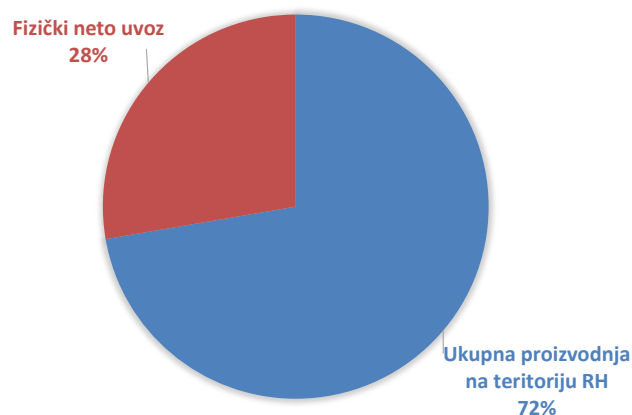
Slika 4.3.1. Struktura nabave električne energije za potrebe hrvatskog elektroenergetskog sustava u 2014.
