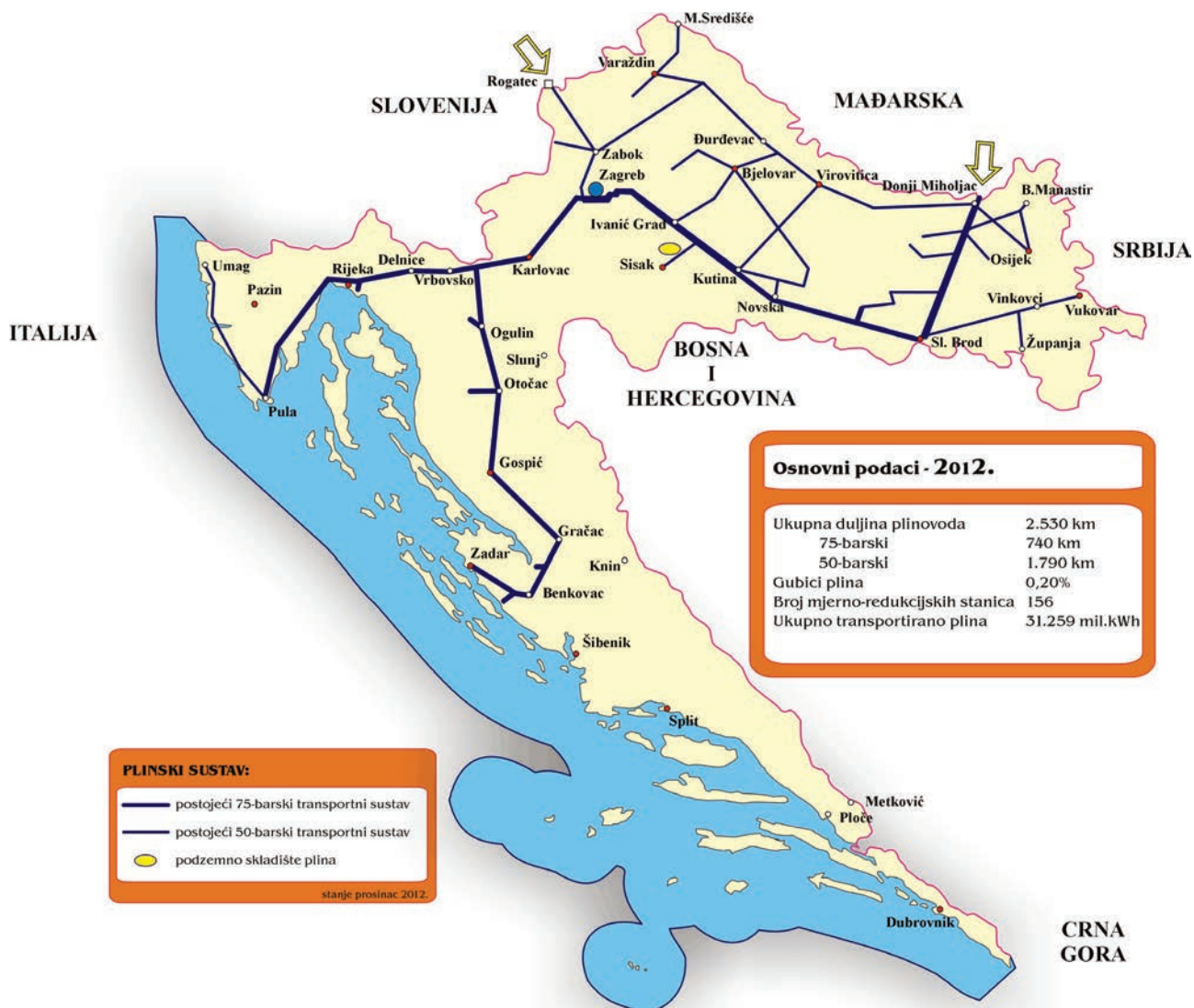
Slika 5.1.1. Postojeći plinski transportni sustav Republike Hrvatske
