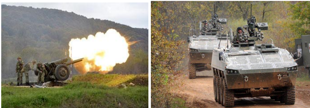
Slika 5. Djelovanje haubice D-30 u potpori taktičkom kretanju kolone borbenih vozila BOV Patria
