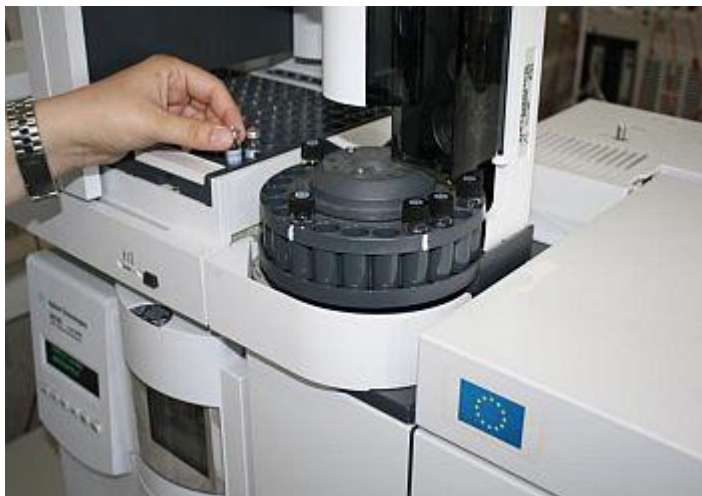
Slika 10.3 – Uređaj GC-MS za analizu nepoznatih tvari, profiliranje amfetamina i bioloških uzoraka na prisutnost droga, nabavljen u sklopu IPA 2007 twinning projekta
